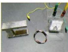
コイルの周りで磁石を動かし磁界を変化させ、誘導電流を発生させます。(検流計の針が左右に振れるので、電流が生じていることがわかります)
