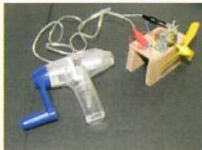
「手回し発電機」を回すと、運動エネルギーが電気エネルギーに変換されます。この電気エネルギーが「モーター」に伝わることで、運動エネルギーに変換され、プロペラが回転します。
